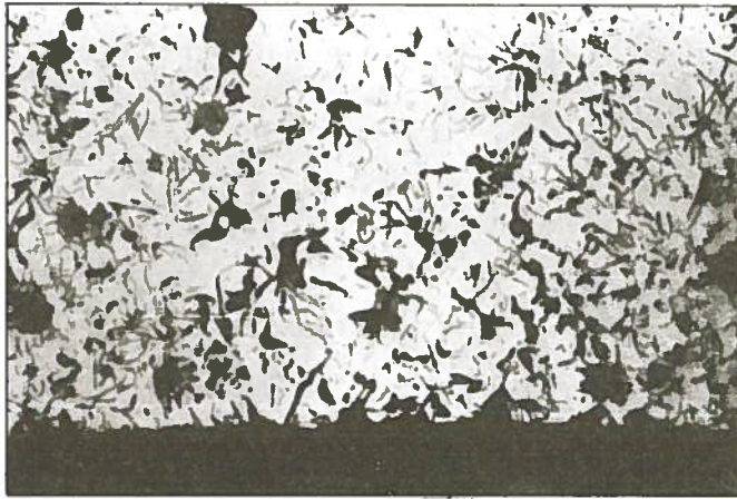
Şekil 8: İşlenmiş müldebak yüzeyi, kullanılmamış. Dağlanmış, 100x
