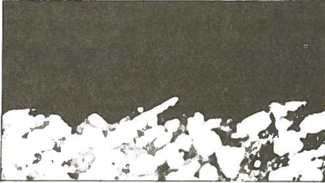
Şekil 10: Anadolu Cam Sanayii A.Ş.'den gelen kalıp yüzeyi kullanılmış, Dağlanmış, 200x
